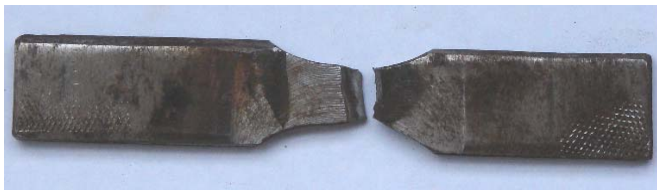
Figura 3.8. Probeta después de realizarle el ensayo de tracción.
