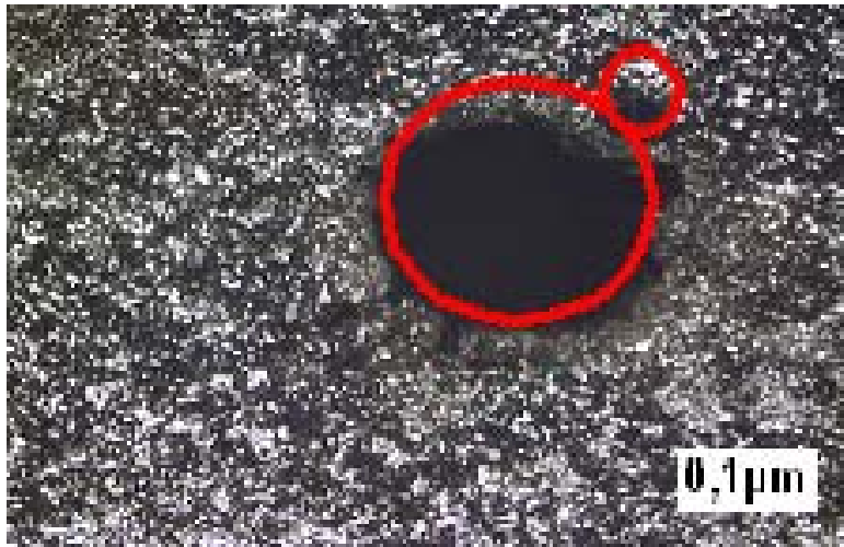
Figura 3.15. Presencia de poros en la soldadura en el tramo cuatro (200 X).
