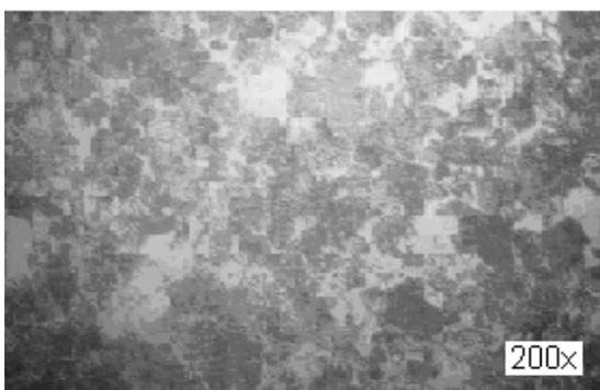
Figura 2.1. Estructura metalográfica ferrita - perlítica del pasador (200x).
