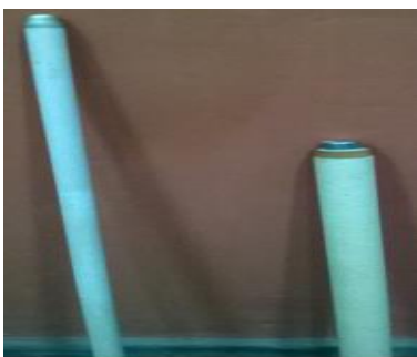
Figura 3 Termopar y Tomamuestra para la toma de temperatura y muestras A la izquierda se encuentra el termopar y a la derecha el Tomamuestra.
