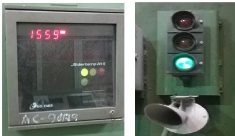
Figura 2. Sidertemp A1- II y semáforo para la toma de temperatura.
