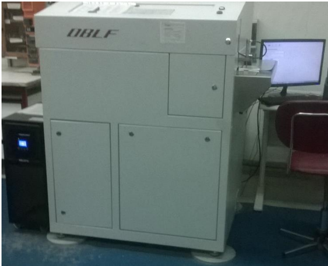
Figura 4 Cuantómetro OBLF QSG 750-II
