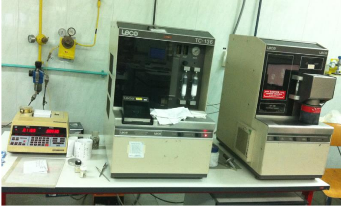
Figura 5 Medidor de nitrógeno y oxígeno LECO TC 136
