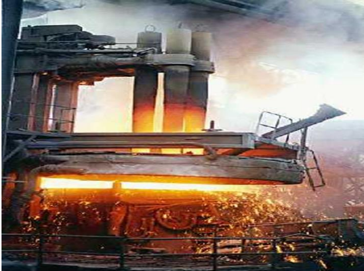
Figura1 Horno de Arco Eléctrico de corriente alterna de ACINOX-Tunas
