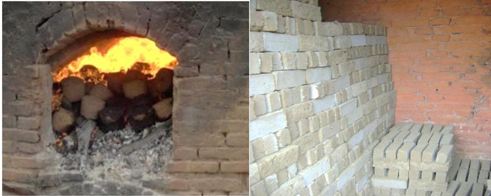
Figura 2.5 Ladrillos en el horno a temperatura de 900 a 1000°C
