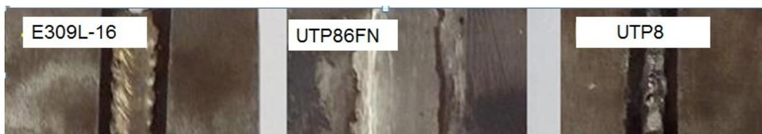
Figura 2.4. Corte de las muestras metalográficas.
