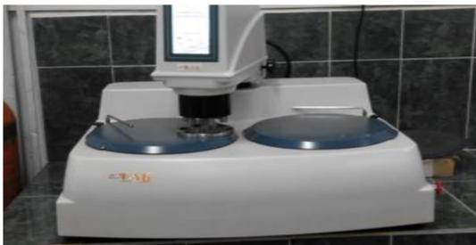
Figura 2.5. Pulidora metalográfica marca PM 52 D.
